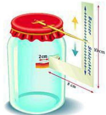
1. Schneidet aus dem Ballon ein großes Stück Haut heraus. Das spannt ihr mithilfe des Gummiringes über die Öffnung des Glases.
